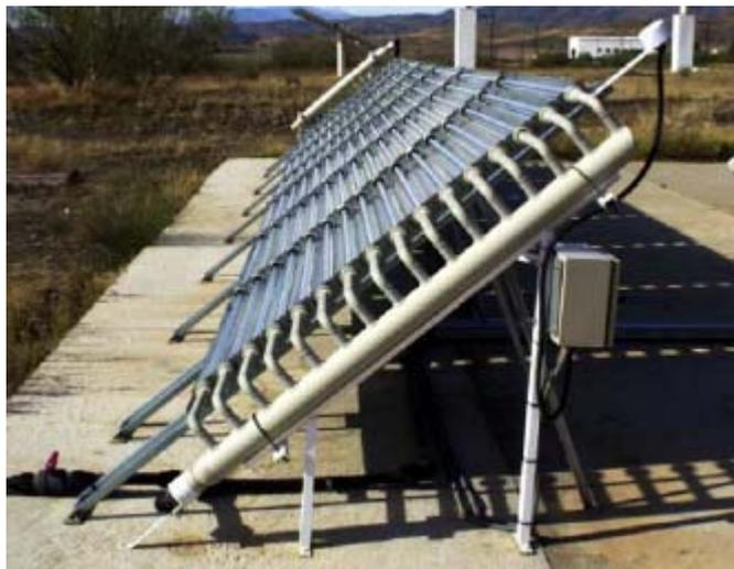
Figura 2.5. Coletores parabólicos desenvolvidos para aplicação fotocatalítica.
