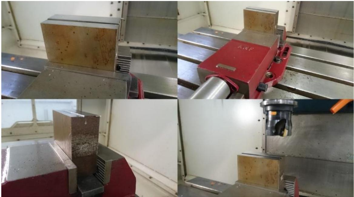
**Figura 27 – Corpo de prova utilizado nos ensaios e seu respectivo sistema de fixação**
