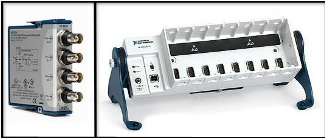
**Figura 32 – Módulo condicionador de sinais e Chassi**
