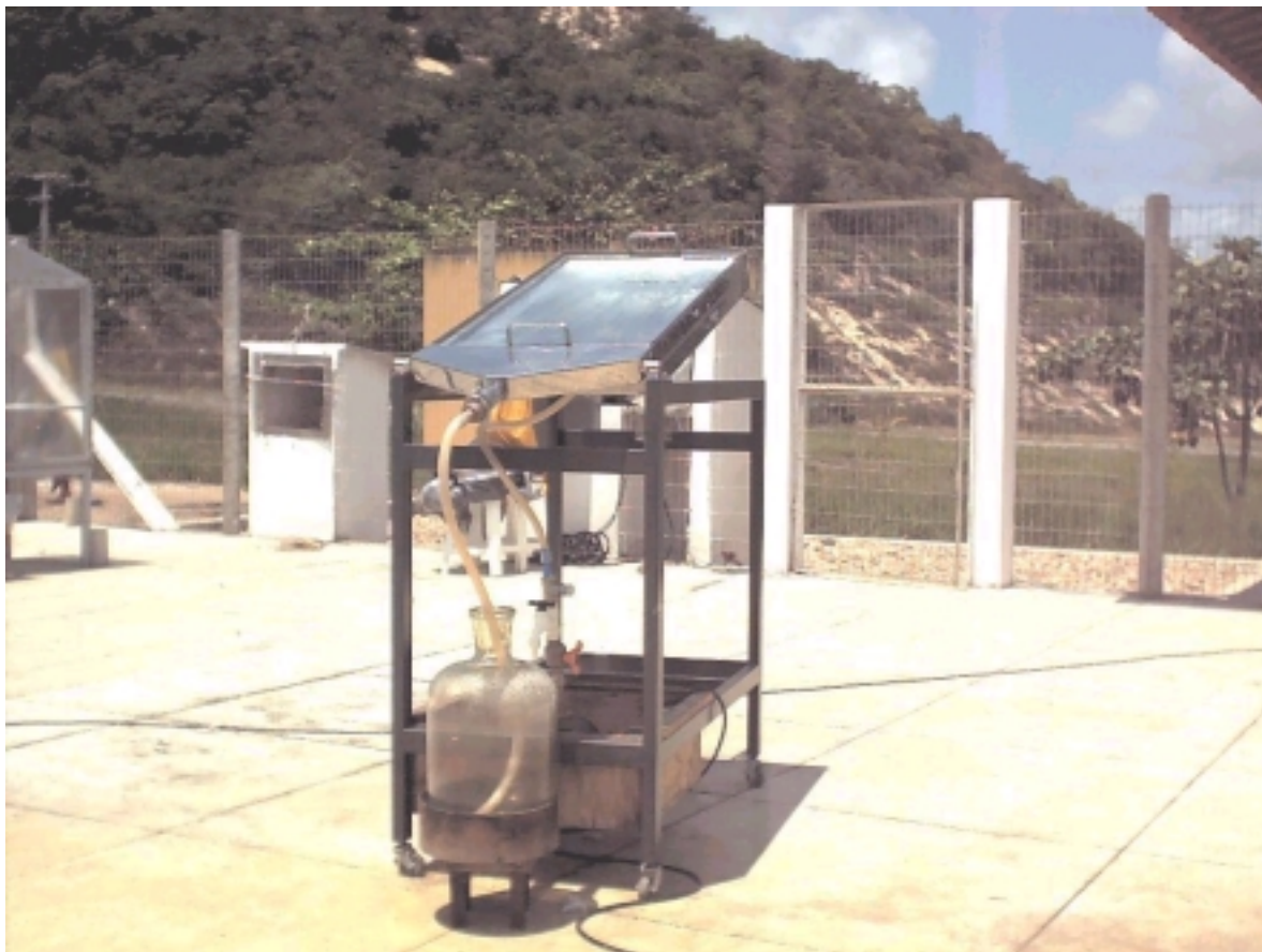
Figura 13. Reator tipo filme instalado no DEQ/UFRN
