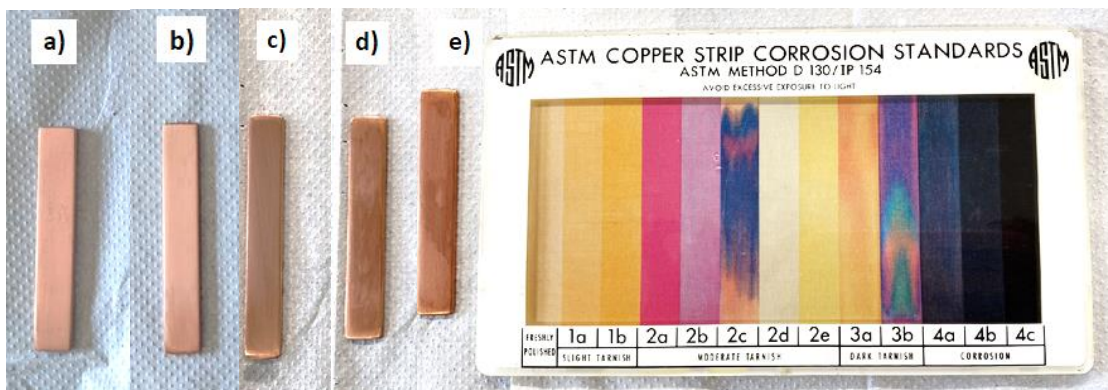
Figura 31 - Lâminas de cobre após análise de corrosividade. a) DB; b) DBM1; c) DBM2; d) DBE1; e) DBE2
