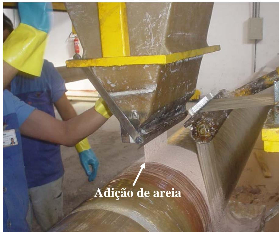
Figura 1: Utilização de areia na fabricação de tubos em PRFV.
