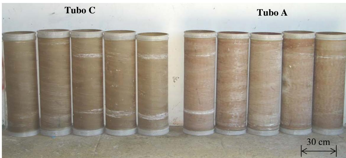
Figura 22: Corpos-de-prova para ensaios hidrostáticos.
