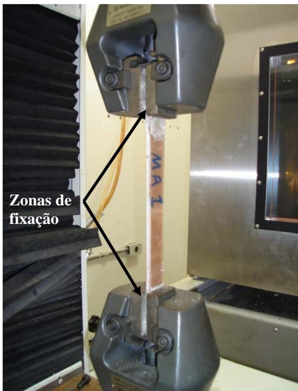
Figura 15: Ensaio de tração axial.
