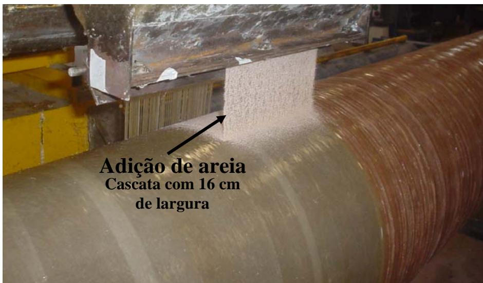
Figura 7: Areia utilizada como agregado nas tubulações de PRFV.
