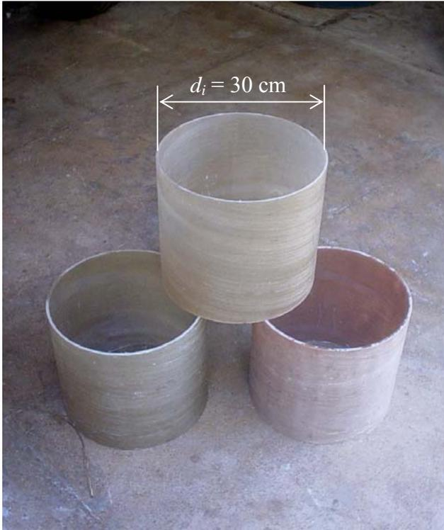
Figura 20: Corpos-de-prova de rigidez
