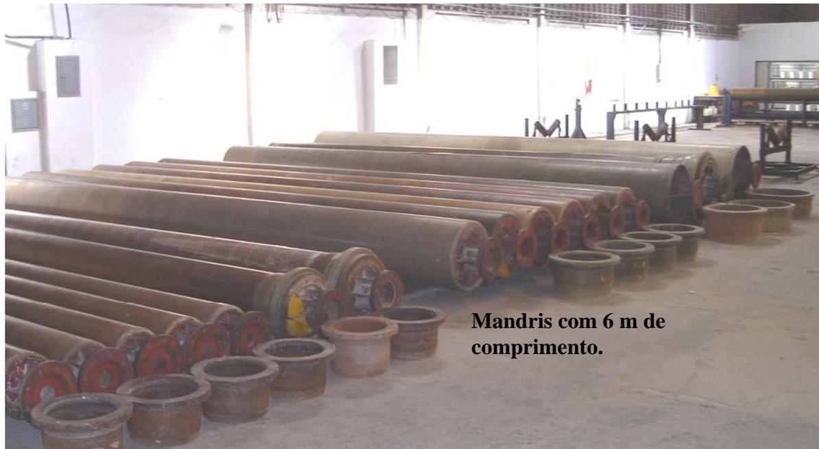
Figura 8: Mandris utilizados para fabricação de tubos.
