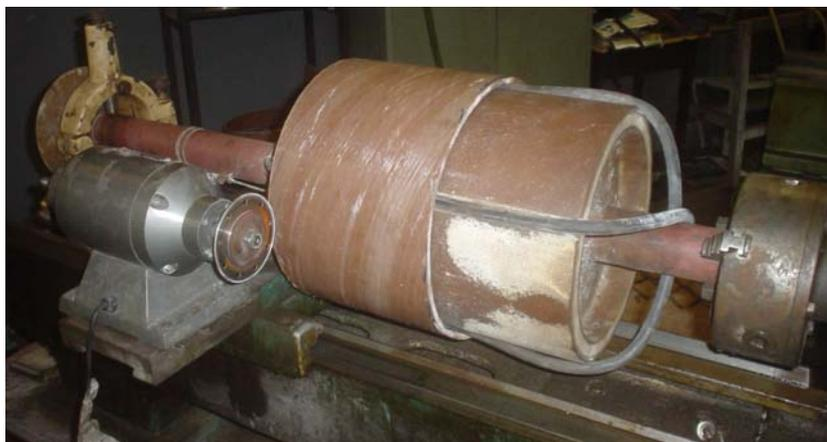
Figura 17: Dispositivo para preparação de corpos-de-prova cilíndricos.
