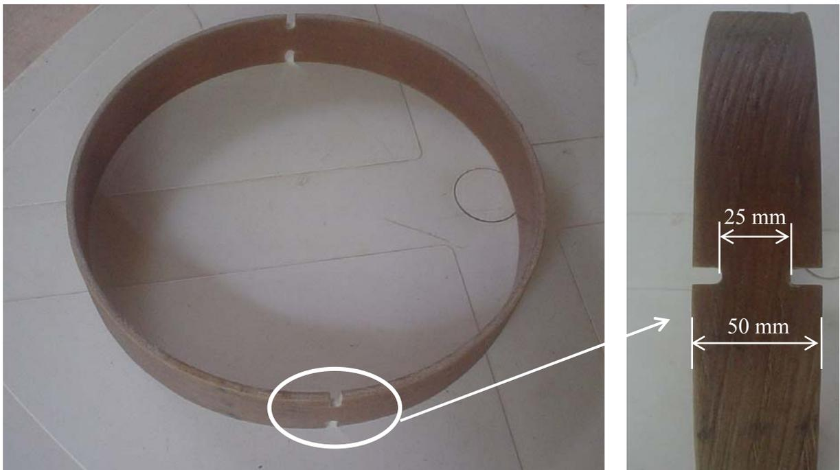
Figura 18: Corpo-de-prova para ensaios de tração circunferencial.
