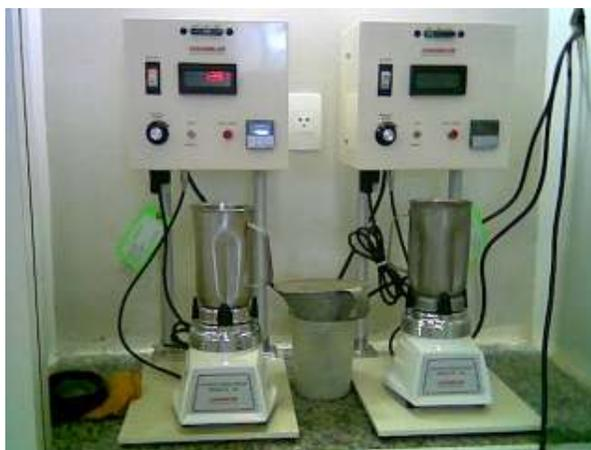
**Figura 6.6** - Misturador de palheta Chandler modelo 80-60 com controlador de velocidade.
