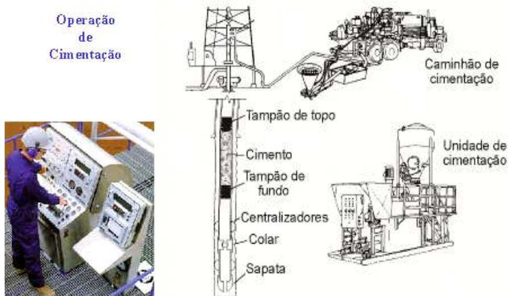
**Figura 3.5** – Esquema de cimentação de poço de petróleo.
