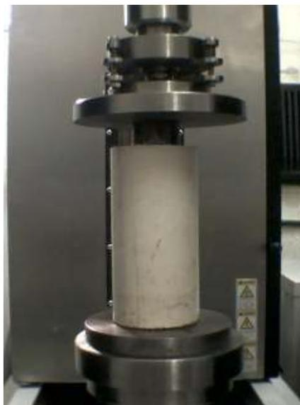
**FIGURA 6.8** – Corpo de prova sobre base vazada para ensaio.
