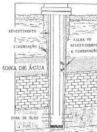
FIGURA 6. Contaminação do óleo produzido devido a falha do revestimento e de sua cimentação
