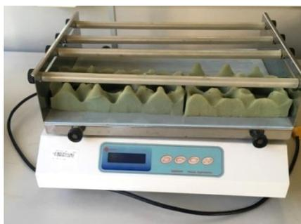
**Figura 5** - Agitador rotacional
