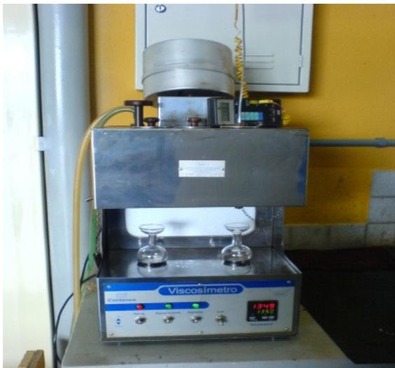
Figura 5.7 - Ensaio de viscosidade utilizando o viscosímetro Saybolt (Pavitest Novus N480D).
