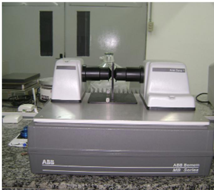
Figura 5.17 - Espectrômetro de infravermelho com transformada de Fourier.
