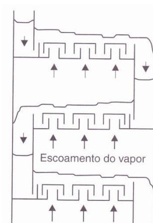
**Figura 3.1- Esquema de separação na Destilação Atmosférica.**
