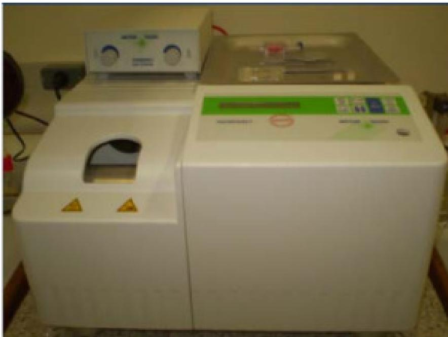
**Figura 5.18 - Termobalança utilizada para as análises termogravimétricas.**
