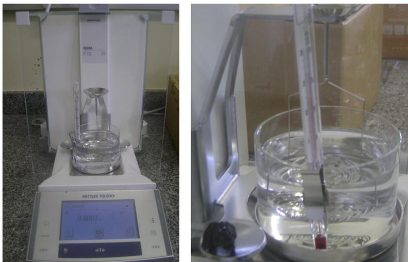
Figura 5.8 - Balança analítica da Mettler Toledo, modelo XS204.
