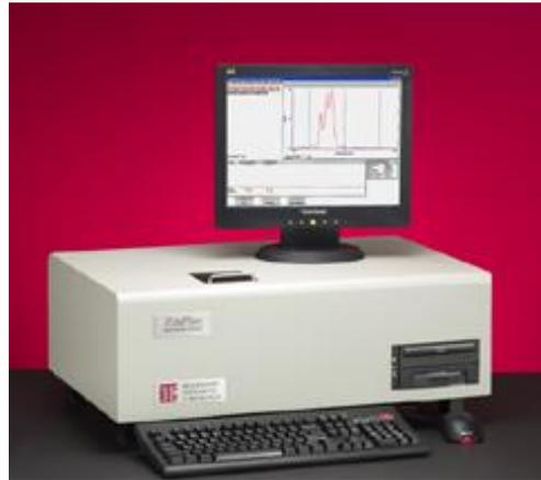
O equipamento ZetaPlus utiliza a técnica de espectroscopia de correlação de fóton (PCS) para fazer as medidas de diâmetro de gota. Essa técnica, também conhecida por espalhamento dinâmico de luz (DLS), é uma das técnicas mais utilizadas para determinar o tamanho de nanopartículas devido à praticidade e rapidez na aquisição dos dados.
