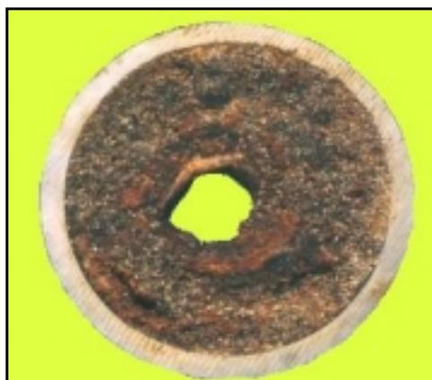
**Figura 3 - Entupimento causado por deposição de orgânicos pesados.**
