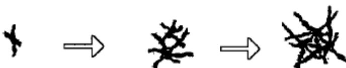
Figura 10 – Uma possível maneira de crescimento dos agregados de asfaltenos.
