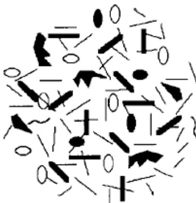
**Figura 4 – Nível microscópico da composição de um petróleo contendo espécies orgânicas pesadas. Bastões e linhas representam moléculas de parafina; elipses abertas, moléculas de resina; elipses sólidas, moléculas aromáticas; e as formas irregulares, asfaltenos.**
