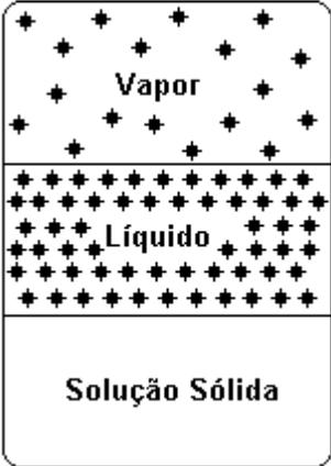
Figura 13 - Modelo característico de solução sólida-líquido-vapor para precipitação de parafinas.
