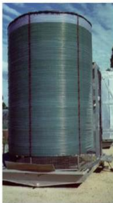
Figura 2.8 - Fotobiorreator tubular com capacidade de 1000L na Universidade de Murdoch, Austrália. Fonte: Chisti, 2007.
