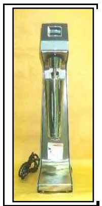
Figura 3.1: Agitador mecânico Hamilton Beach-Fann, utilizado para a formulação dos fluidos de perfuração.
