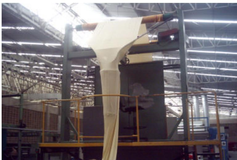
Figura 18 – Abridor de Malha Circular
