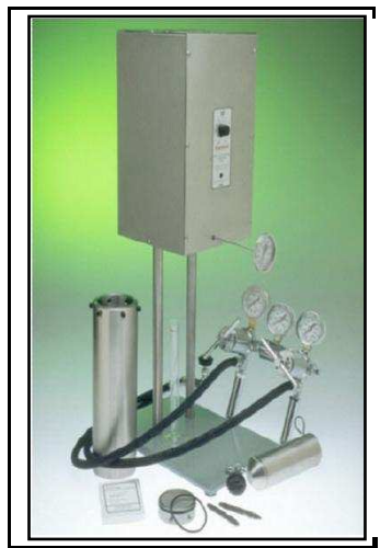
Figura 3.2: Fann HPHT Filter Press Series 387 – Filtro utilizado na nova metodologia.
