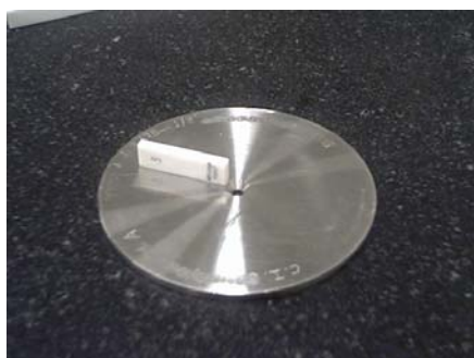
Figura 24. Placa de orifício
