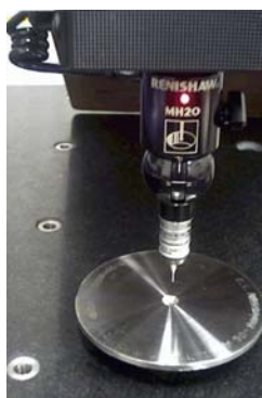
Figura 29. Medição do diâmetro da placa de orifício
