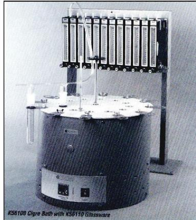
**Figura 28:** Bloco de oxidação
