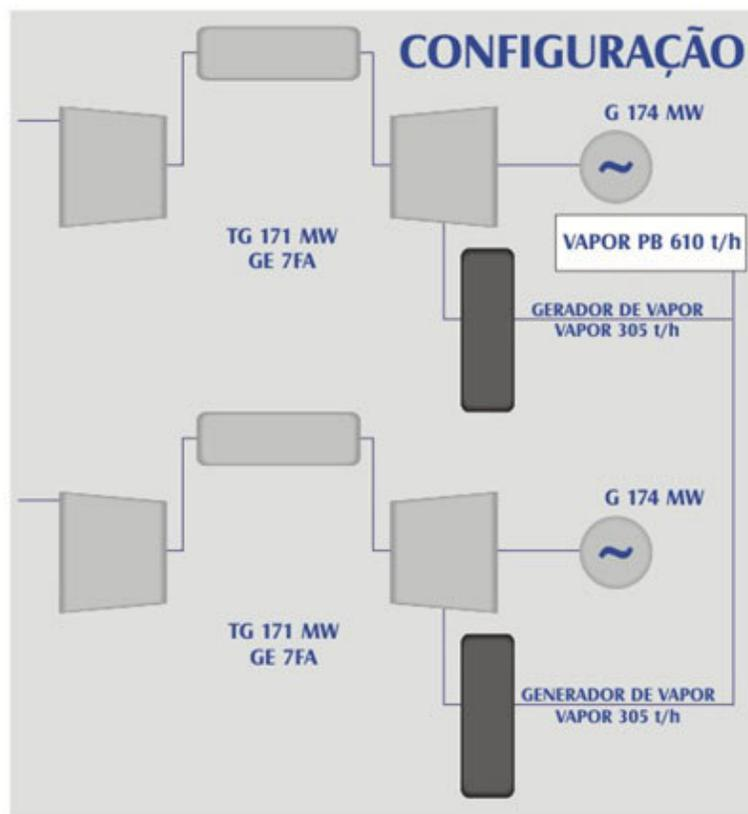
Figura 5 – Configuração de geração e co-geração de energia
