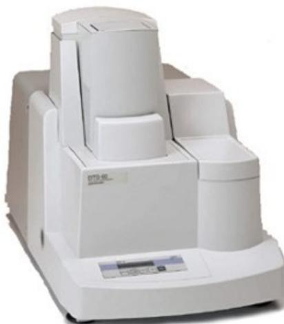
Figura 89 - DSC-60 Plus Shimadzu. Fonte: Shimadzu.
