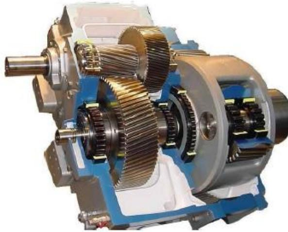
Figura 15. Caixa multiplicadora (Fabricante – Winergy – Vestas – V80)
