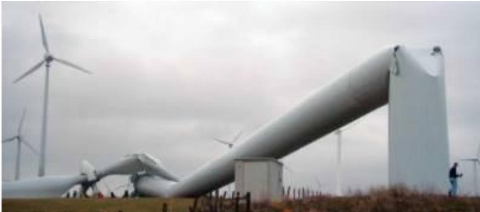
Figura 20. Ruptura da estrutura de um Aerogerador [4]
