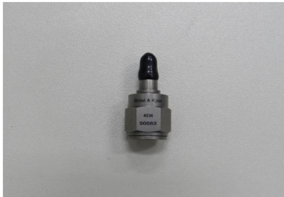
Figura 29 – Acelerômetro piezoelétrico.
