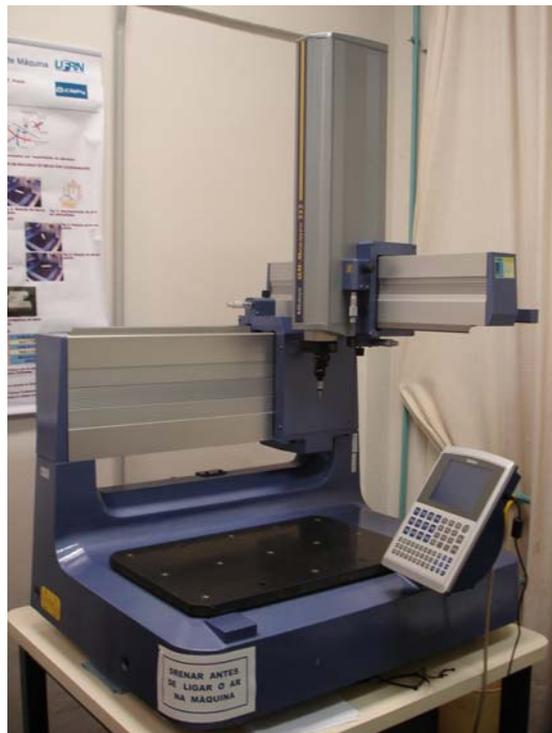
Figura 2 – Máquina de medir por coordenadas tipo coluna do Laboratório de Metrologia da UFRN.
