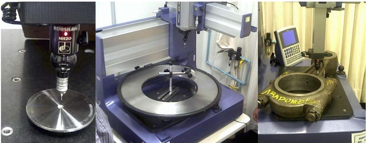
Figuras 39, 40 e 41 respectivamente – Placa de orifício com diâmetro nominal de 3/8"; placa de orifício com diâmetro nominal de 360mm; biela de um motor de compressão de gás.
