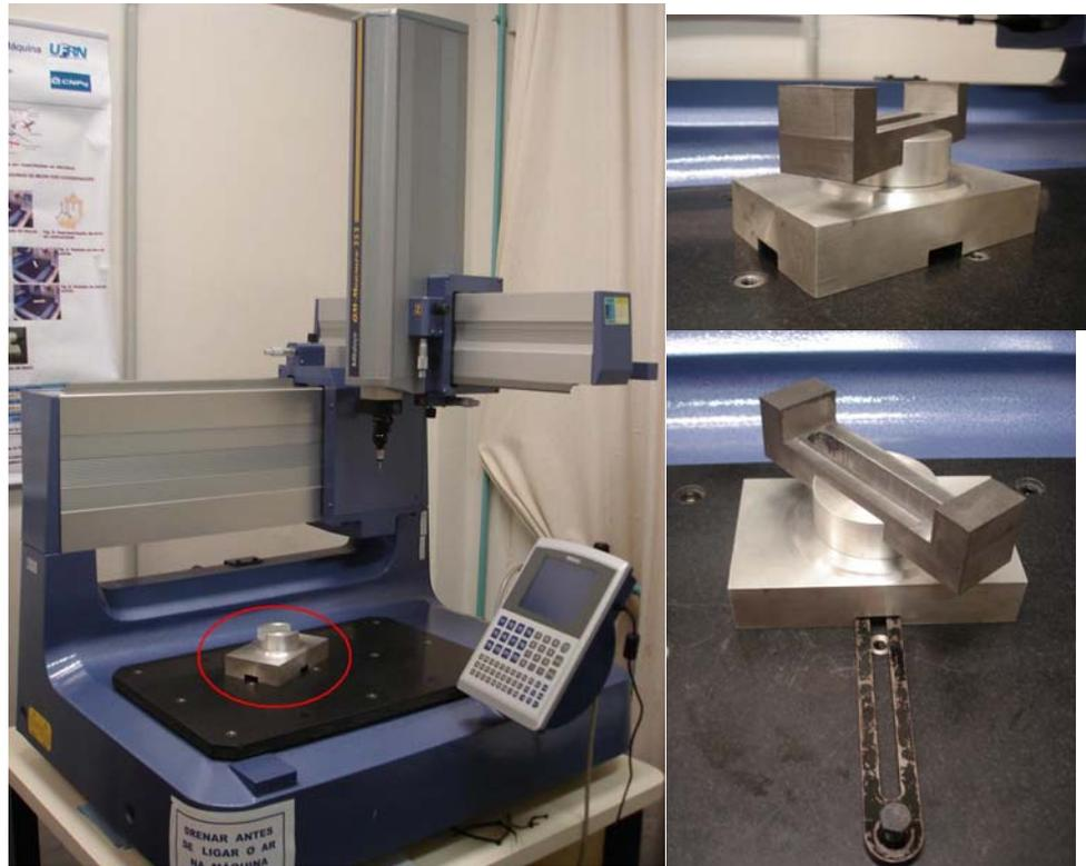
Figura 31 – Dispositivo para fixação de peças em fase de construção.
