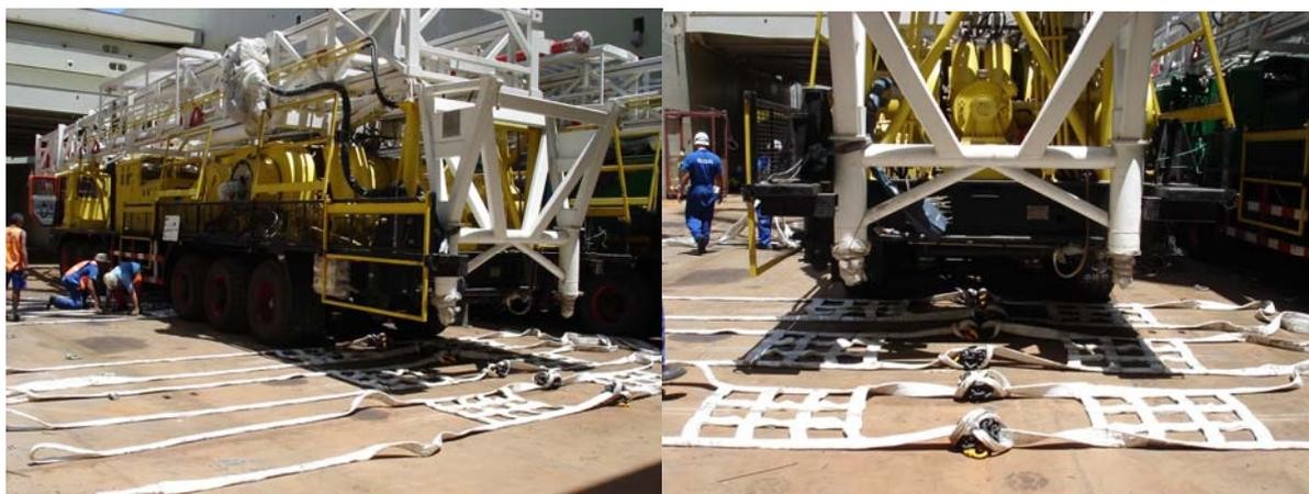
Figura 6 – Montagem das redes de elevação.
