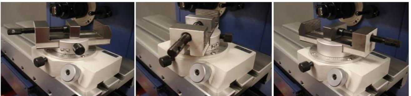
Figura 6 – Mesa para fixação de peças do Projetor de Perfil.
