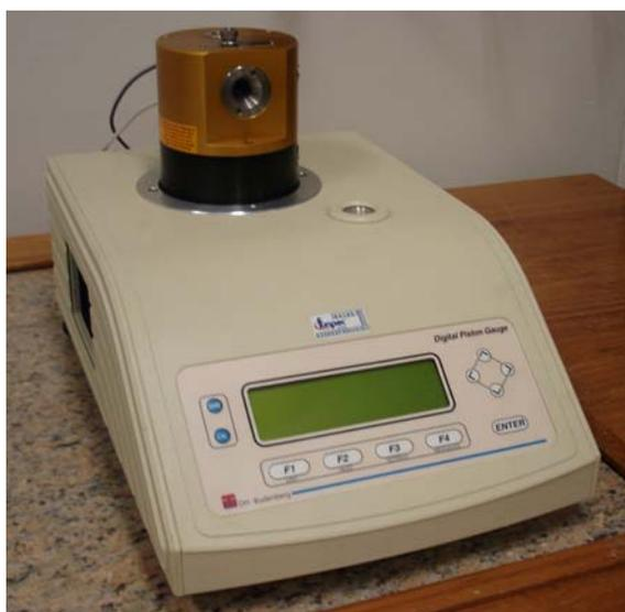
Figura 4.7 – Balança de Pressão do tipo pistão invertido (padrão).
