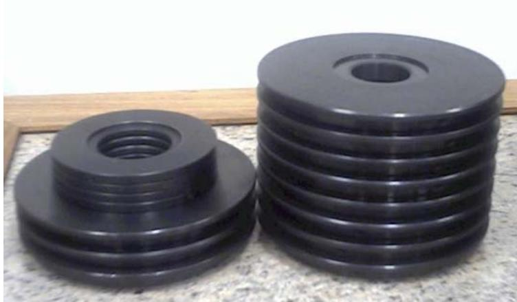
Figura 4.1 – Coleção de massas da balança de pressão.
