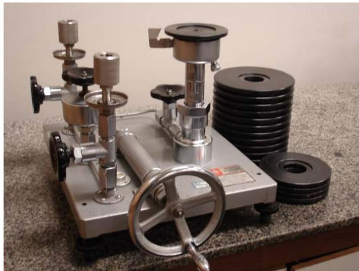
Figura 4.6 – Balança de Pressão do tipo peso morto (mensurando).
