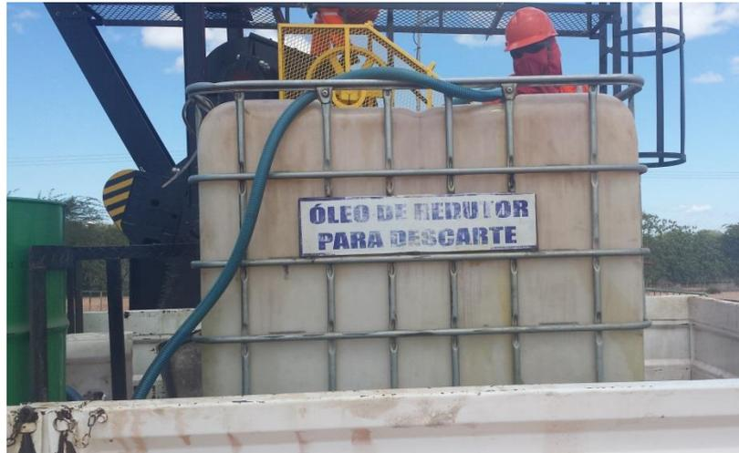
Figura 39 - Reservatório para óleo lubrificante que será descartado.
