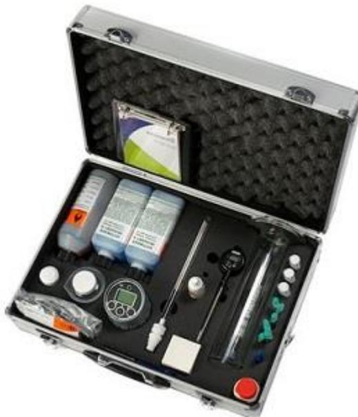
Figura 27 - Foto da maleta da Kittiwake que faz análise de óleo lubrificante.
