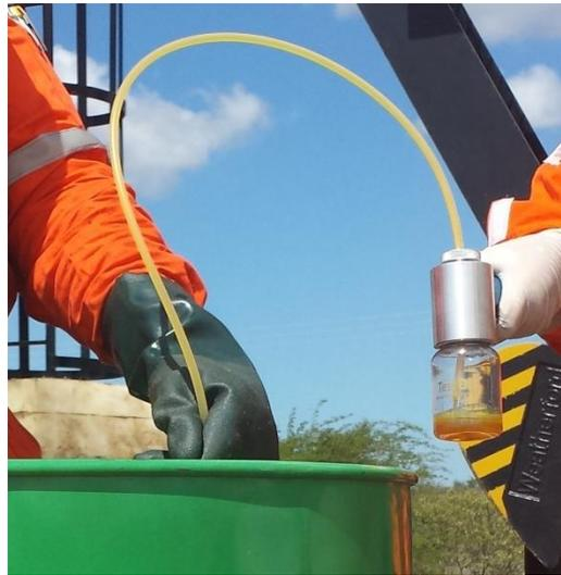
Figura 37 - Coleta com bomba de vácuo.
