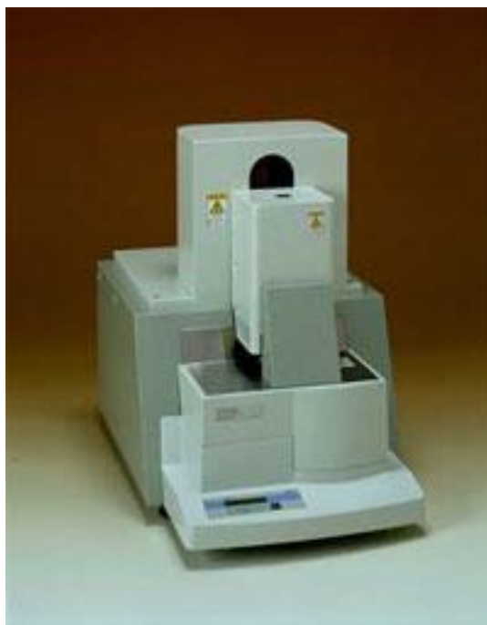
Figura 13. Analisador Térmico Shimadzu DTG-60 com controlador de fluxo modelo FC-60A.
