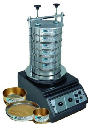
Figura 2. Agitador eletromagnético para peneiras Bertel.
