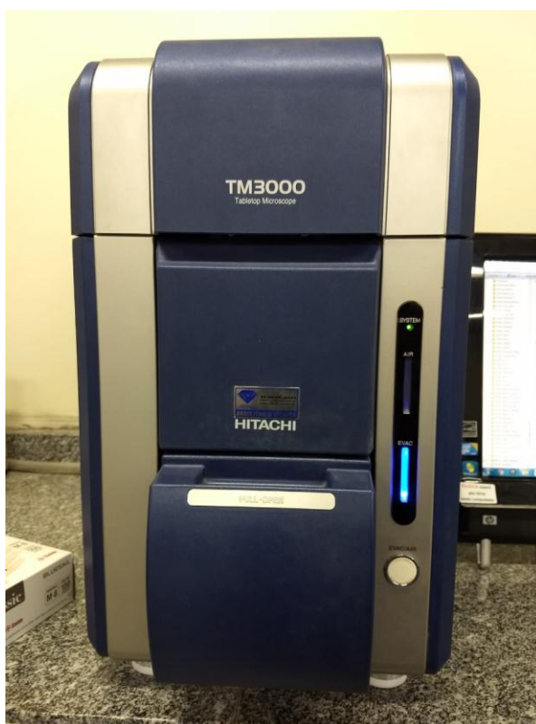
Figura 11. Microscópio eletrônico de varredura Hitachi, modelo TM 3000.
