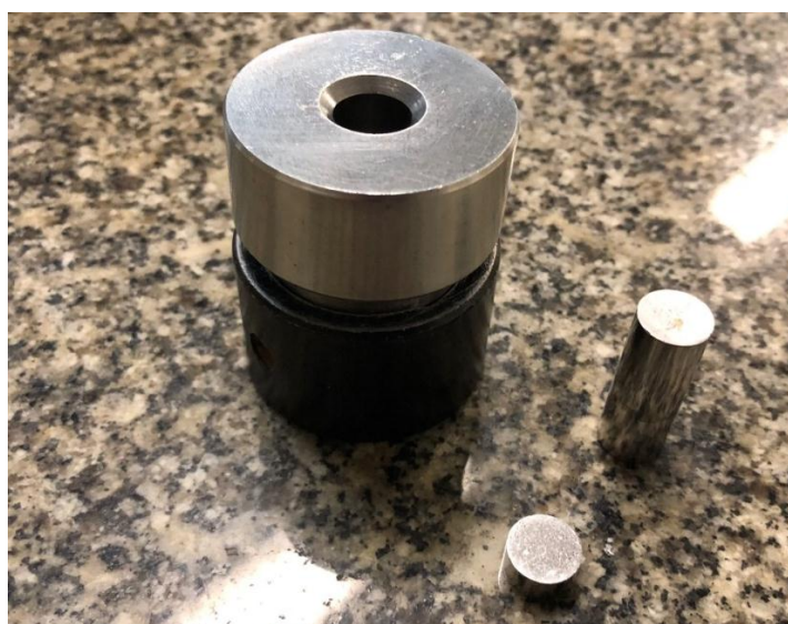
Figura 8. Molde para preparação da pastilha de fibra de coco.
