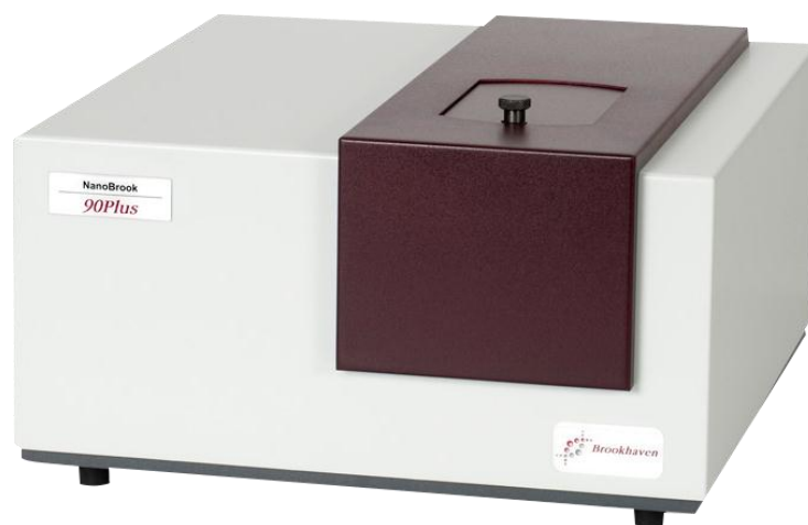
Figura 7. Analisador de diâmetro de partícula ZetaPlus 90Plus.
