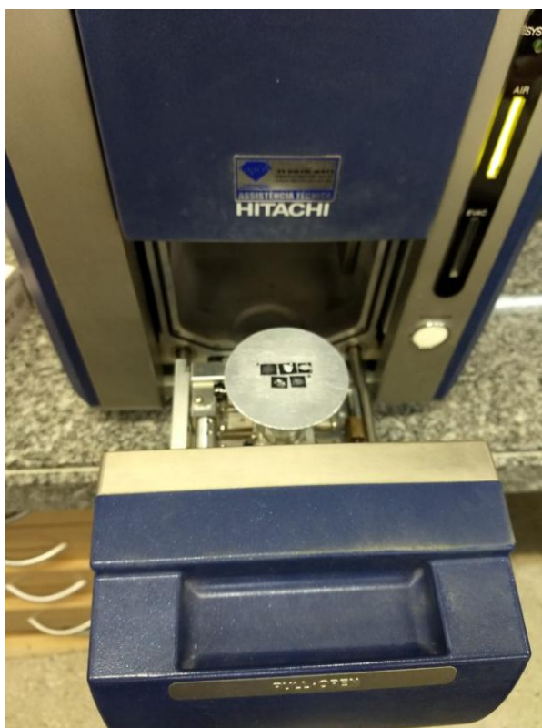
Figura 12. Amostras no microscópio eletrônico de varredura Hitachi, modelo TM 3000.
