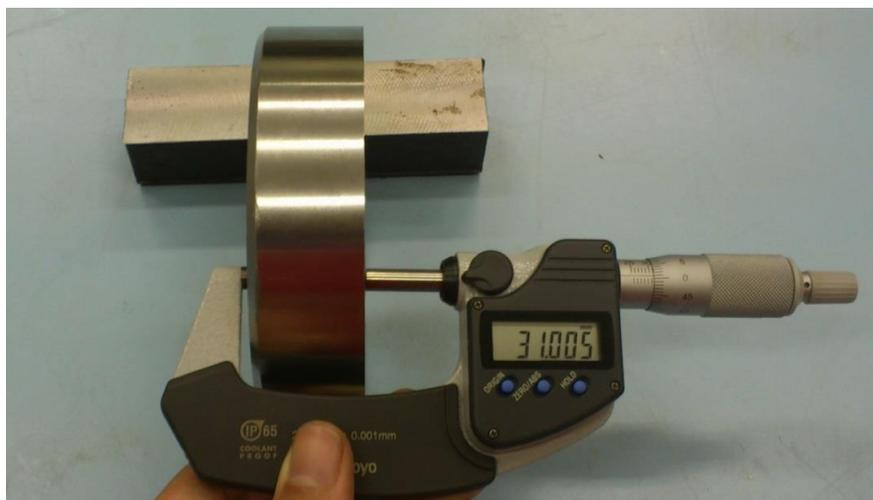
Figura 24: Medição da espessura do corpo-de-prova com o micrômetro Mitutoyo IP 65.
