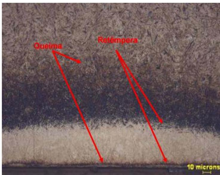
Figura 11: Microestrutura após a retificação de um corpo-de-prova com queima e retêmpera.
