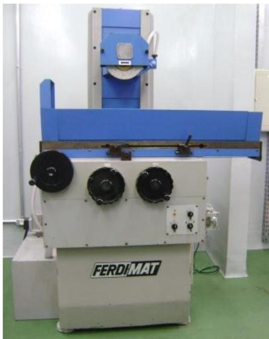
*Figura 15: Retificadora FerdMat, modelo TA31 utilizada nos experimentos.*
