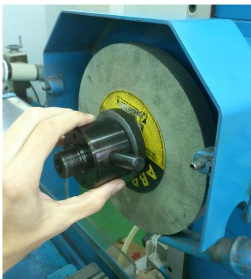
Figura 20: Troca do rebolo. Fixação através de um flange roscado.
