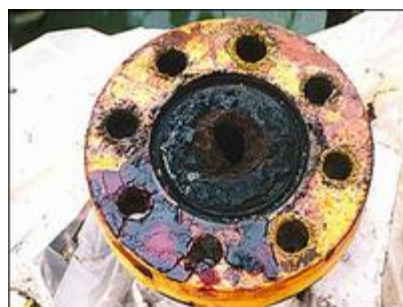
Figura 1: Linha parcialmente bloqueada por deposição de parafina.
