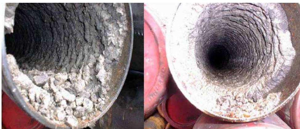
Figura 2.2: Incrustação provocada pela água produzida.
