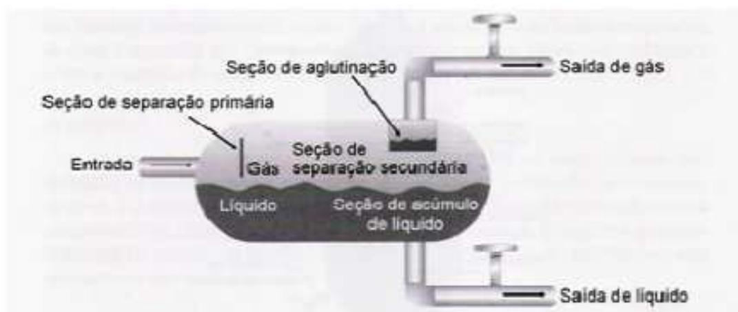
Figura 2.3: Esquema de um separador bifásico.
