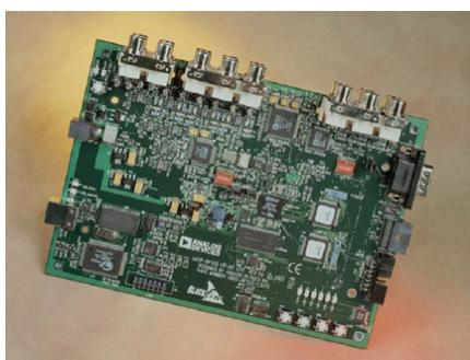
**Figura 2 – Placa de desenvolvimento com um DSP**
