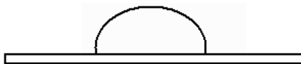
Figura 4.6 - Representação de uma barra de metal e uma gota adsorvida na superfície.
