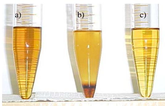
Figura 5.11 - Comparação entre o óleo usado (a), o óleo tratado por extração com microemulsão (c) representa o equilíbrio em WI na extração por microemulsão (b)
