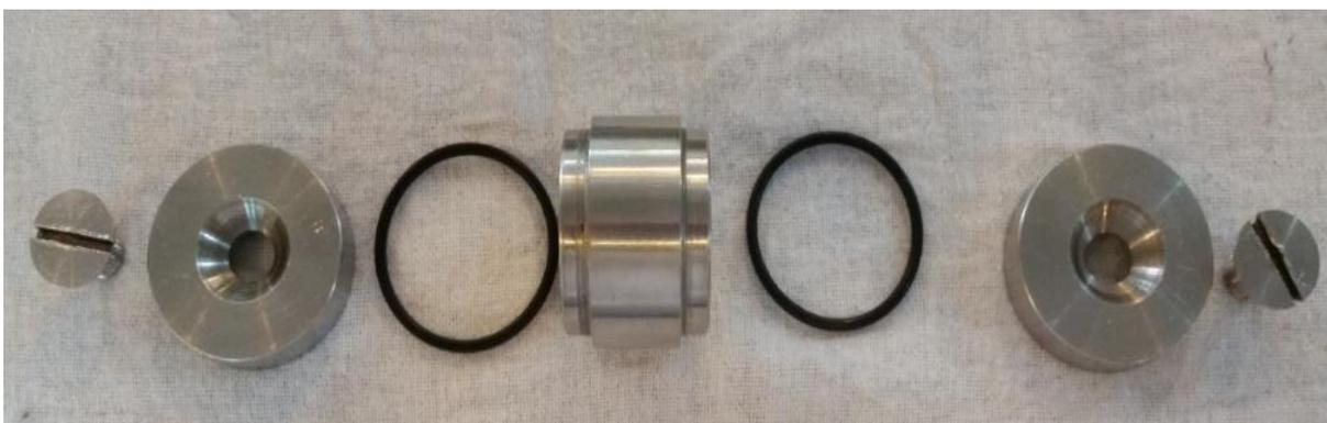
**Figura 31.** Pistão montado com todos os componentes, pronto para entrada na célula. Fonte: autor.
