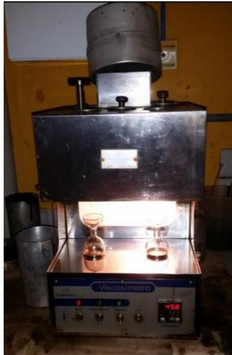
No método Saybolt, a amostra de óleo é alimentada ao equipamento, a passagem de óleo do recipiente do aparelho é feita através de um orifício calibrado, para um frasco de 60 mL, verificando-se o tempo decorrido para seu enchimento até o traço de referência (60 mL).
