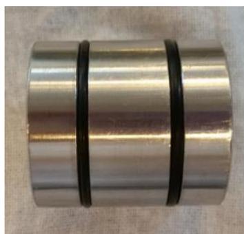
**Figura 32.** Bomba seringa para pressurização do sistema. Fonte: autor.
