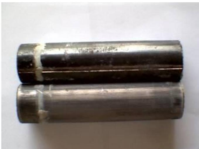
**Figura 3.7** – Tubo de aço utilizado como revestimento no ensaio de aderência
