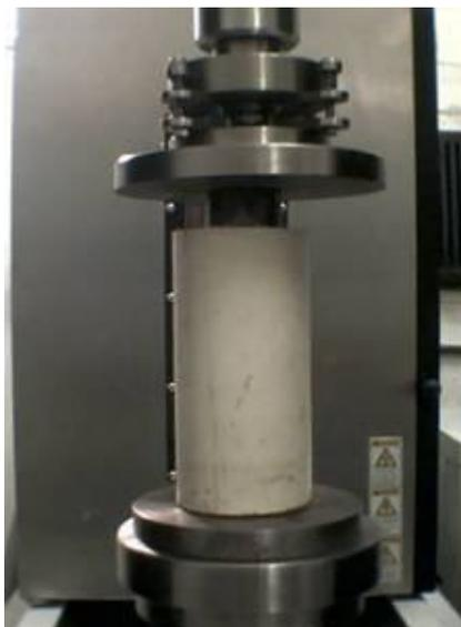
**Figura 3.4** – Corpo de prova sobre base vazada para ensaio [FREITAS, 2007].
