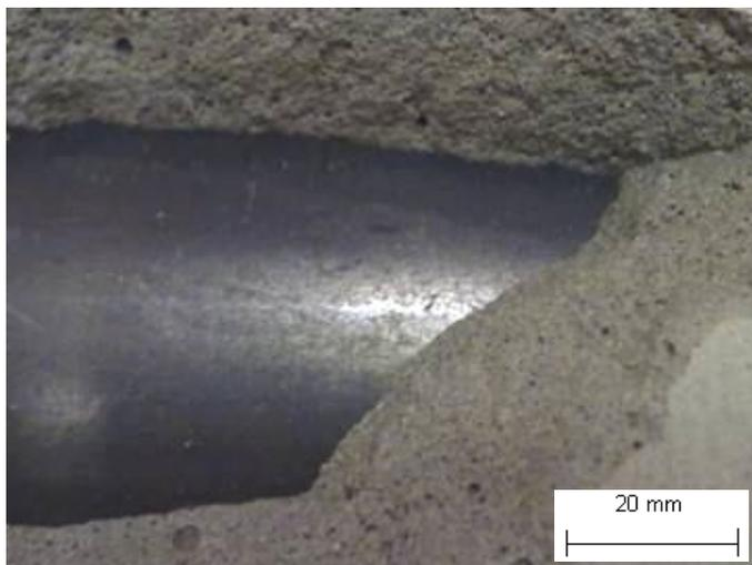
**Figura 4.9** – Imagem da interface do revestimento metálico-bainha de cimento com 5% de borracha triturada 14 dias de cura.
