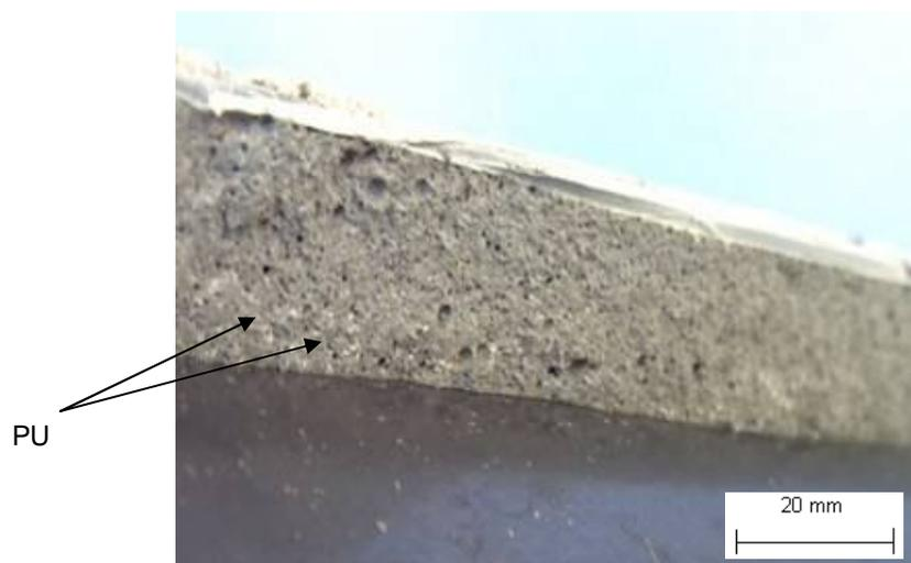
**Figura 4.19** – Imagem da interface do revestimento metálico-bainha de cimento com 5% de poliuretana 14 dias de cura.
