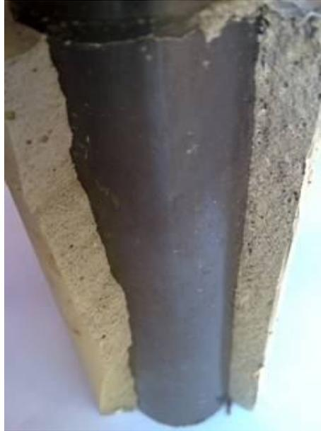
**Figura 3.8** – Tubo de aço envolvido pela bainha de cimento.
