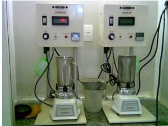
**Figura 3.16** - Misturador de palheta Chandler modelo 80-60 com controlador de velocidade.
