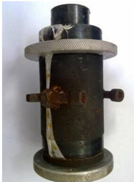
**Figura 3.14** - Molde de aço definido para os ensaios de aderência com aquecimento.
