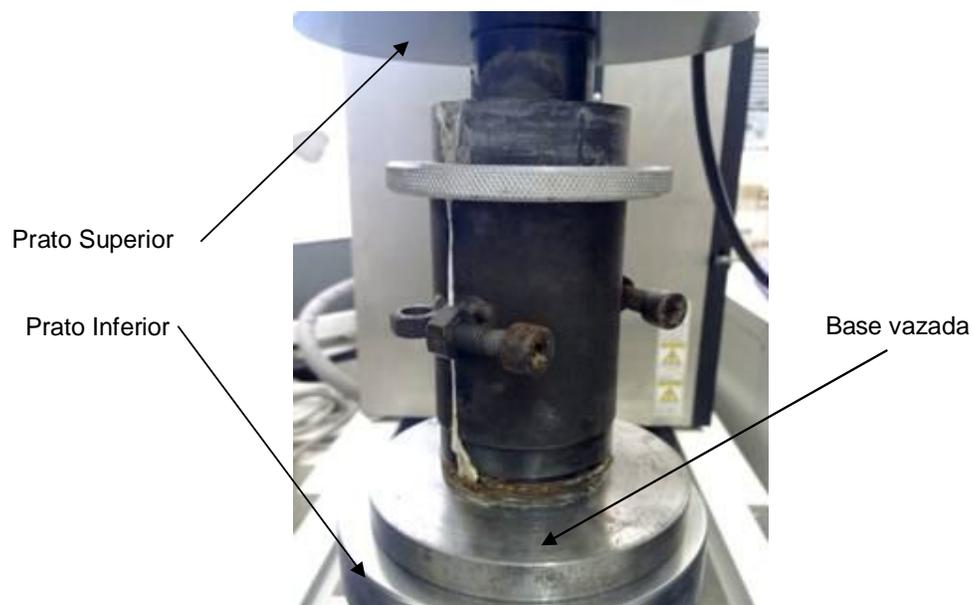
**Figura 3.18** – Corpo de prova sobre base vazada para ensaio.
