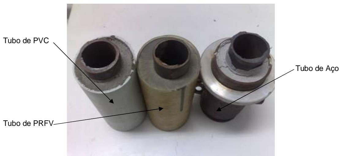
**Figura 3.5** – Moldes utilizados para os ensaios de aderência
