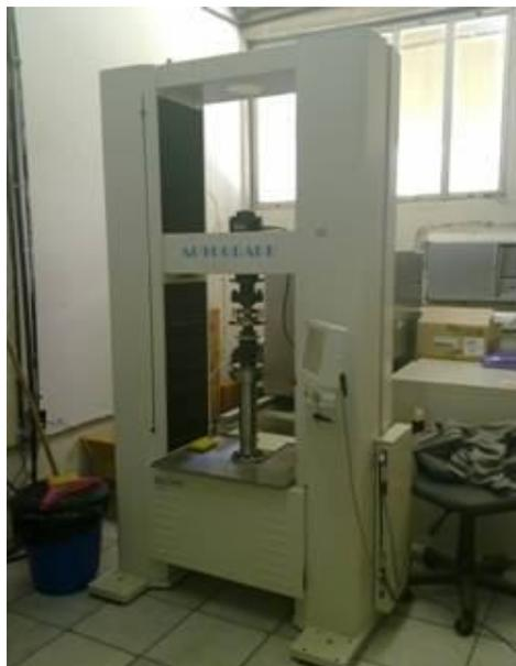
**Figura 3.17** – Máquina de ensaio uniaxial Shimadzu AG-I.
