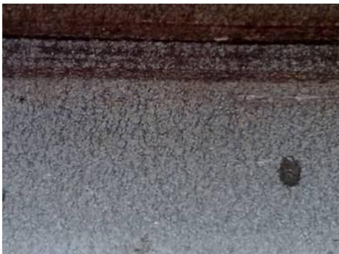
**Figura 4.35** – Borracha triturada na parte interna da bainha cimentante.
