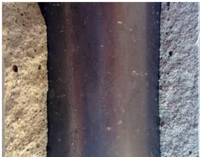
**Figura 4.31** – Imagem da interface revestimento metálico bainha de cimento da pasta padrão após ciclagem térmica.
