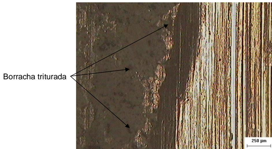
**Figura 4.8** - Micrografia óptica da pasta com adição de 5% de borracha triturada com 28 dias de cura.
