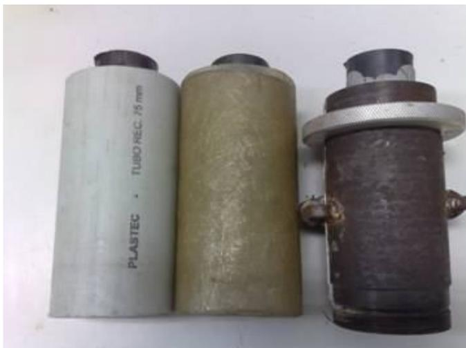
**Figura 3.6** – Moldes utilizados para os ensaios de aderência
