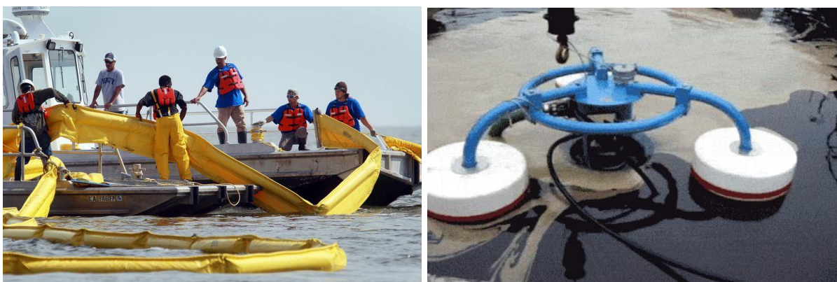
Figura 1. À esquerda, barreiras flutuantes de contenção. À direita, skimmers .
