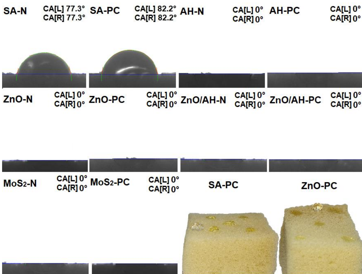
Figura 23. Ângulo de contato entre o óleo lubrificante S46 e a superfície das espumas novas (N) e pós-comercializadas (PC): sem alteração (SA), revestidas com ácido hexadecanóico (AH), enxertadas com óxido de zinco (ZnO), revestidas e enxertadas (ZnO/AH) e impregnadas com dissulfeto de molibdênio (MoS 2 ); fotografias das espumas SA-PC e ZnO-PC com gotas de água do mar e de óleo lubrificante S46 sobre suas superfícies.
