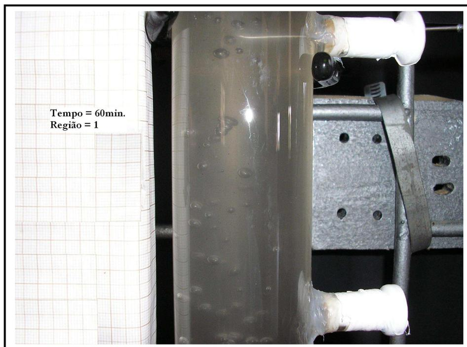
Figura 28. (a) Registro fotográfico das bolhas de ar na região R = 1 (base da coluna) para o filtro nº 0.
