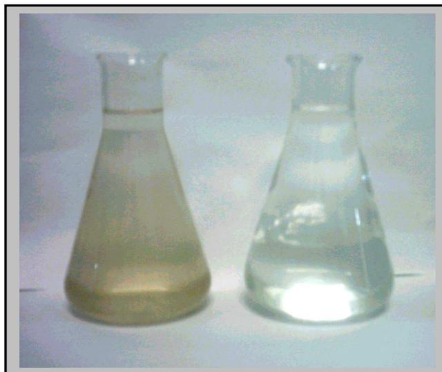
Figura 53. Amostras da água de produção na sua concentração inicial (esquerda) e após o tratamento na coluna com tensoativo OCS (direita).
