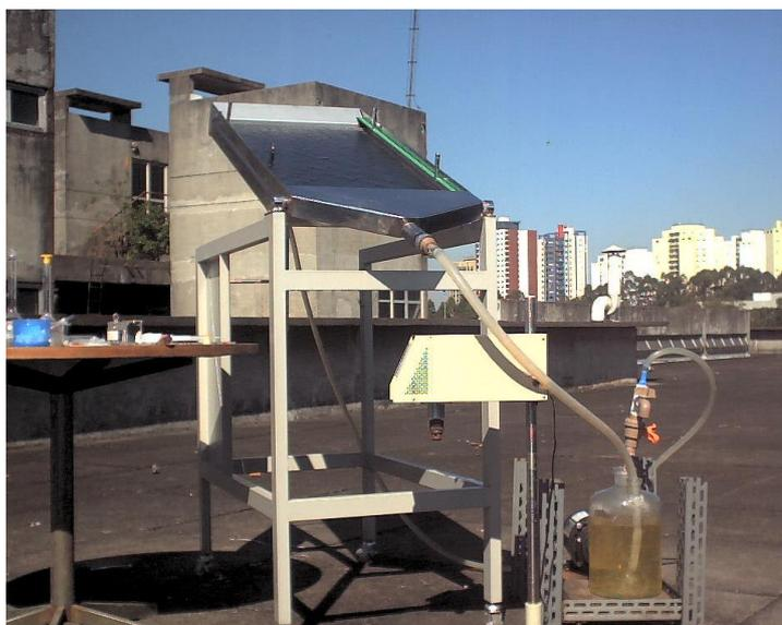
Figura 4.1 – Reator fotoquímico solar do tipo filme (DEQ/USP)
