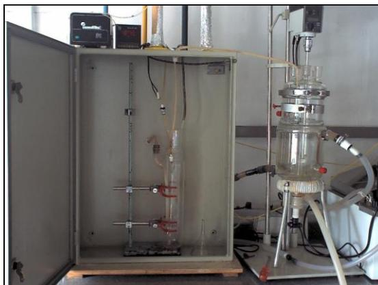
Figura 3.1 – Reator fotoquímico com fonte artificial de radiação UV
