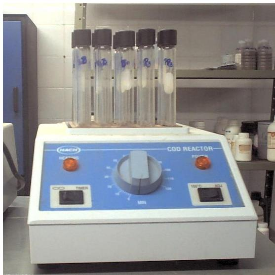
Figura 6.2 – Reator digestor de DQO (HACH COD Reactor)
