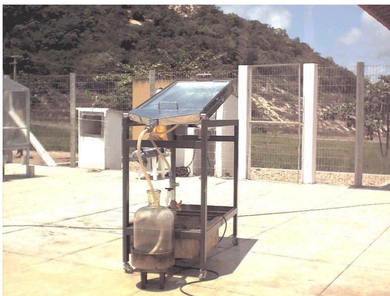
Figura 6.1 – Reator fotoquímico solar do tipo filme (DEQ/UFRN)
