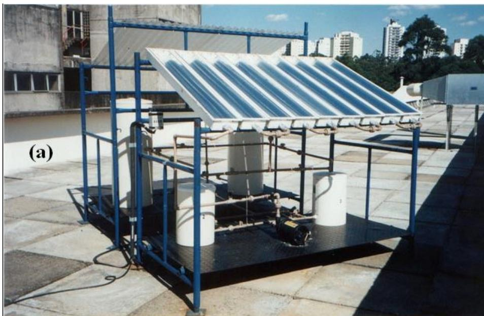
Figura 2.11. Foto do reator parabólico tubular ou “parabolic trough reactor” (PTR).
