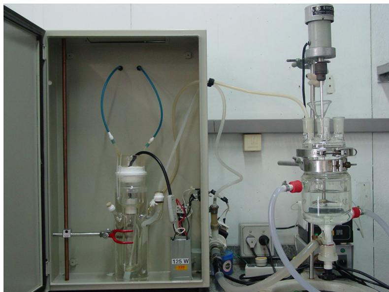
Figura 4.2. Foto do reator fotoquímico de batelada (bancada).
