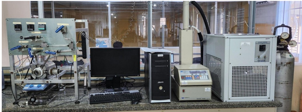
Figura 2 - Aparato experimental da célula PVT. Fonte: Autoria própria (2024)
