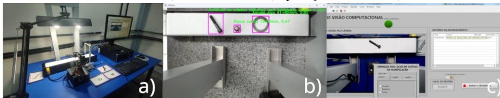
Figura 2. Sistema de VC do FMS. a) Sistema Físico. b) aplicação YOLOv8. c) YOLOv8 no LabView.
