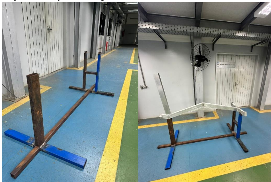
Figura 2: Conjunto do suporte montado e chassi do veículo sobre ele.
